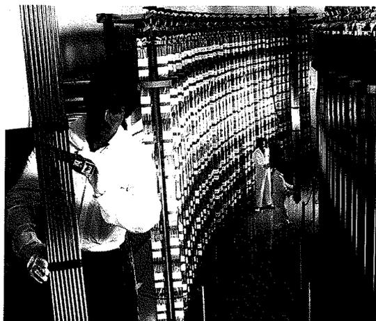
*L'énergie électrique produite par un assemblage combustible dans une centrale nucléaire équivaut approximativement à l'énergie produite par 3 500 tonnes de charbon dans une centrale classique. La photo de couverture montre des assemblages combustibles subissant un ultime examen avant leur installation dans la cuve du réacteur. Les chiffres les plus récents de l'AEN montrent que la part du nucléaire dans la production d'électricité dans la zone de l'OCDE atteint presque 21 pour cent.*
