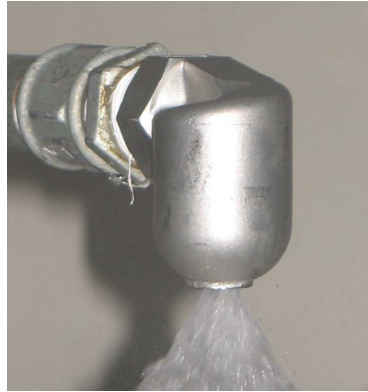
Fig. 2: Spray nozzle SPRACO 1713A (Lechler).
