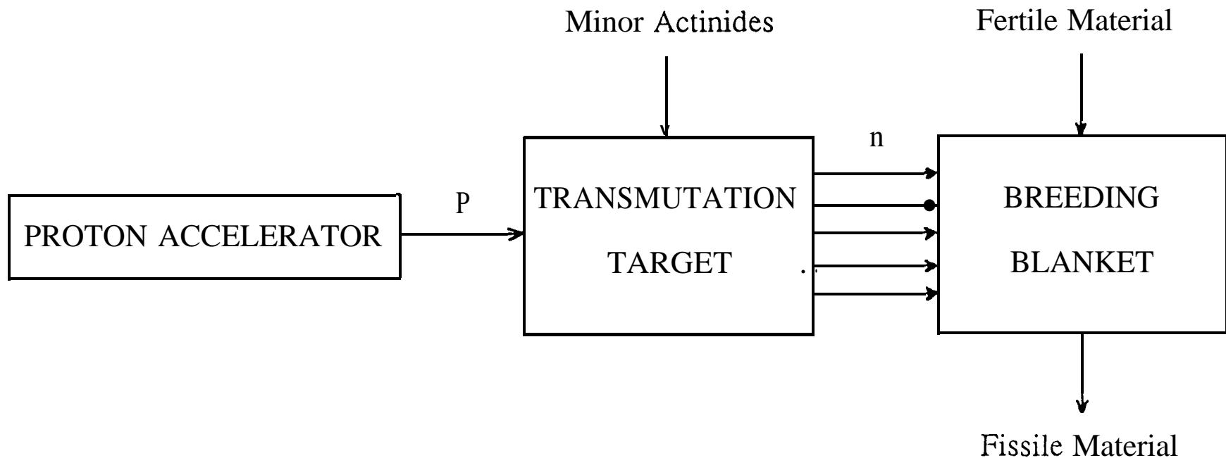
HIGH POWER ACCELERATOR DRIVEN TARGET-BLANKET SYSTEM
