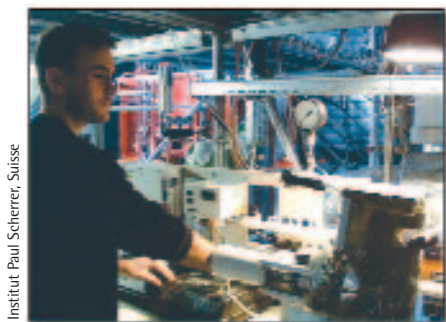
Mesures des concentrations locales de gaz à l'intérieur de l'installation expérimentale PANDA en Suisse.
